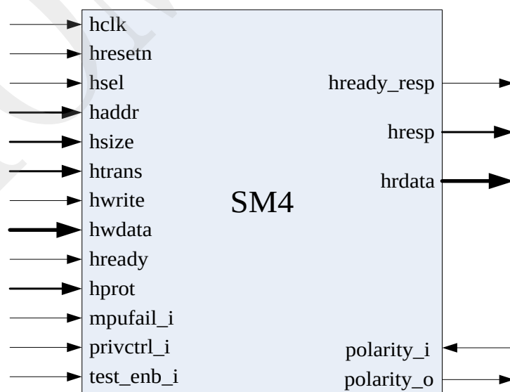
图表 26-1 SM4 算法模块接口定义
