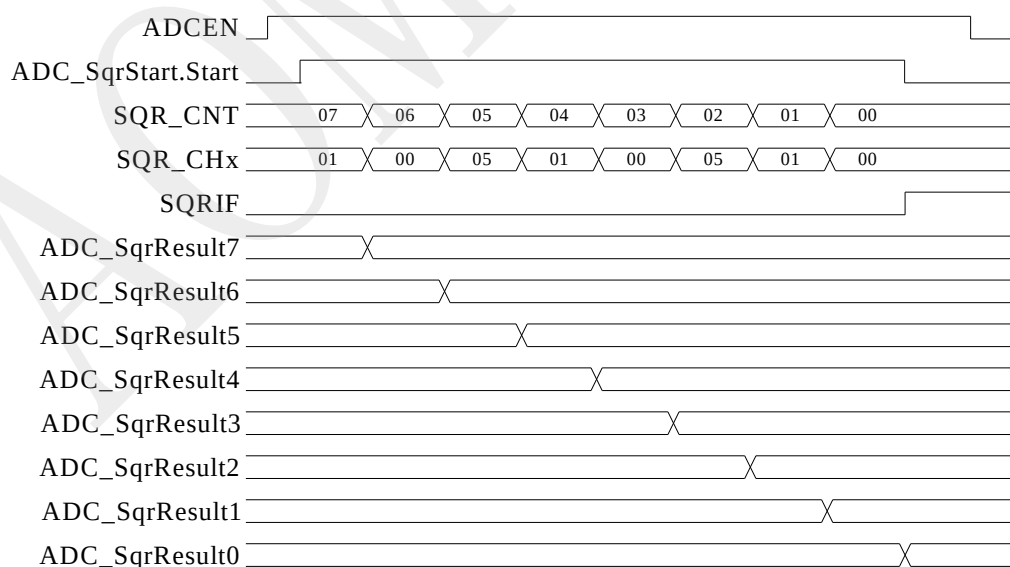
图 40-3 ADC 顺序扫描转换过程示例
