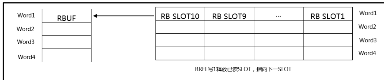
图 22-4 CAN RBUF 寄存器读接收缓冲器示意图
