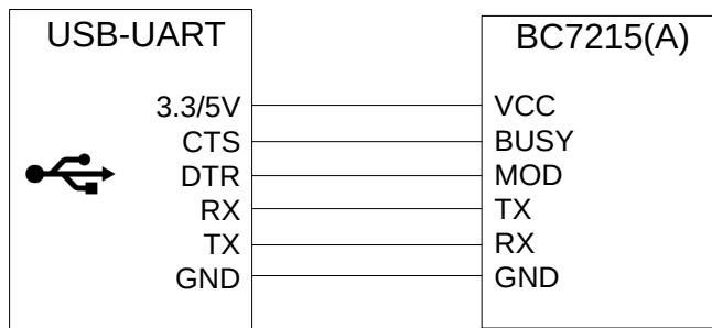
亦可使用任何支持硬件流控制的串口工具用于控制本演示板，关于串口工具，我们推荐使用跨平台的开源项目“comtool”：<https://neucrack.com/p/186>
