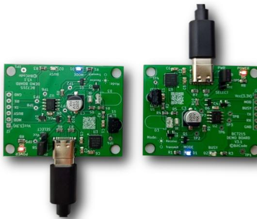
这个实验需要 2 块 BC7215 演示板，可以分别连接 2 台电脑，或者同一台电脑的两个不同 USB 口，然后同时运行 2 份演示程序。请将发射和接收端的红外接收头和发射管相对，两块板之间的距离，最远可大约 10 米，同于普通红外遥控器的作用距离。选择通讯演示界面、Hex Data 模式，并选择一个红外编码格式，一般来说通讯两边应选择一样的设置。
