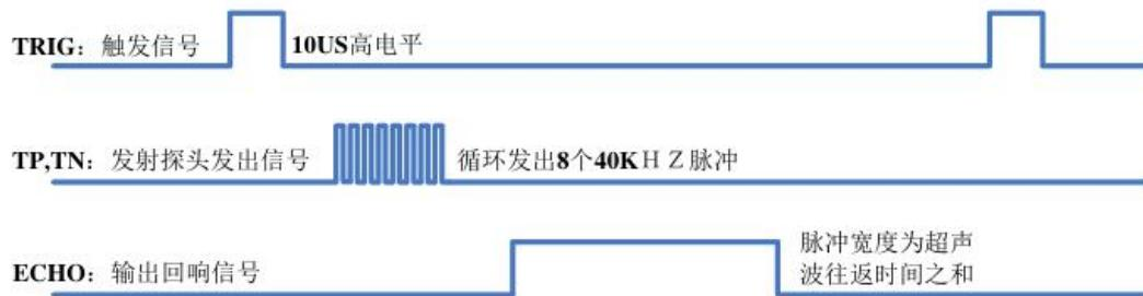
以上时序图表明你只需要提供一个 10uS 以上脉冲触发信号，该模块内部将发出 8 个 40kHz 周期电平并检测回波。一旦检测到有回波信号则输出回响信号。回响信号的脉冲宽度与所测的距离成正比。由此通过发射信号到收到的回响信号时间间隔可以计算得到距离。公式：距离=高电平时间\*声速（340M/S）/2。
